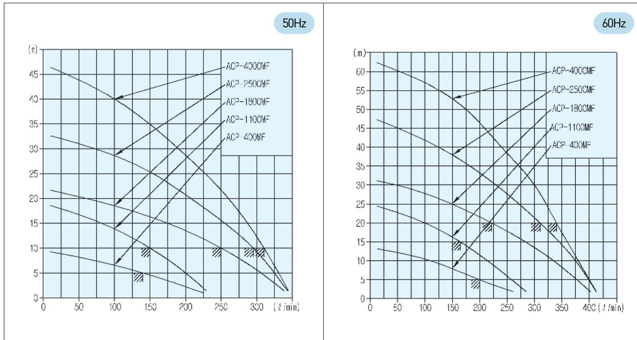
※위 Data는 유온 40°C, 점도 2cSt에서 작성 되었다. (Above data was tested in the viscosity 2cSt, oil temperature. 40 °C.)
