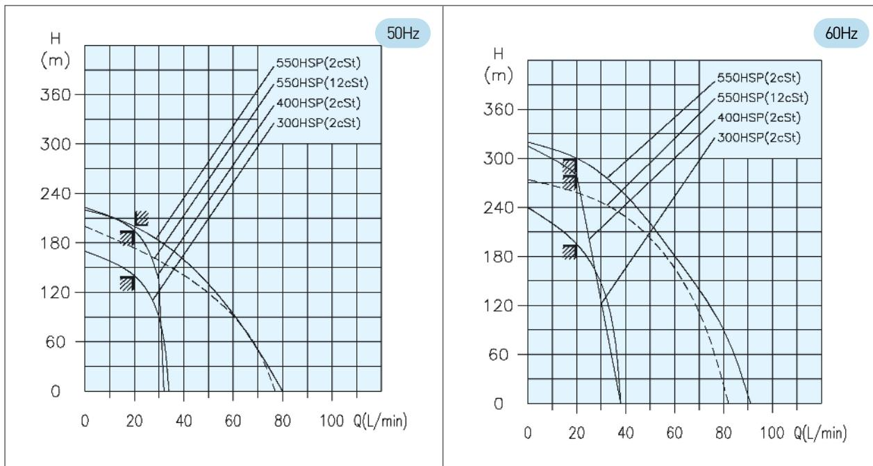
\*위 Data는 유온 40°C, 점도 2cSt, 12cSt에서 작성 되었다. [Above data was tested in the viscosity 2cSt, 12cSt, oil temperature. 40°C.]
