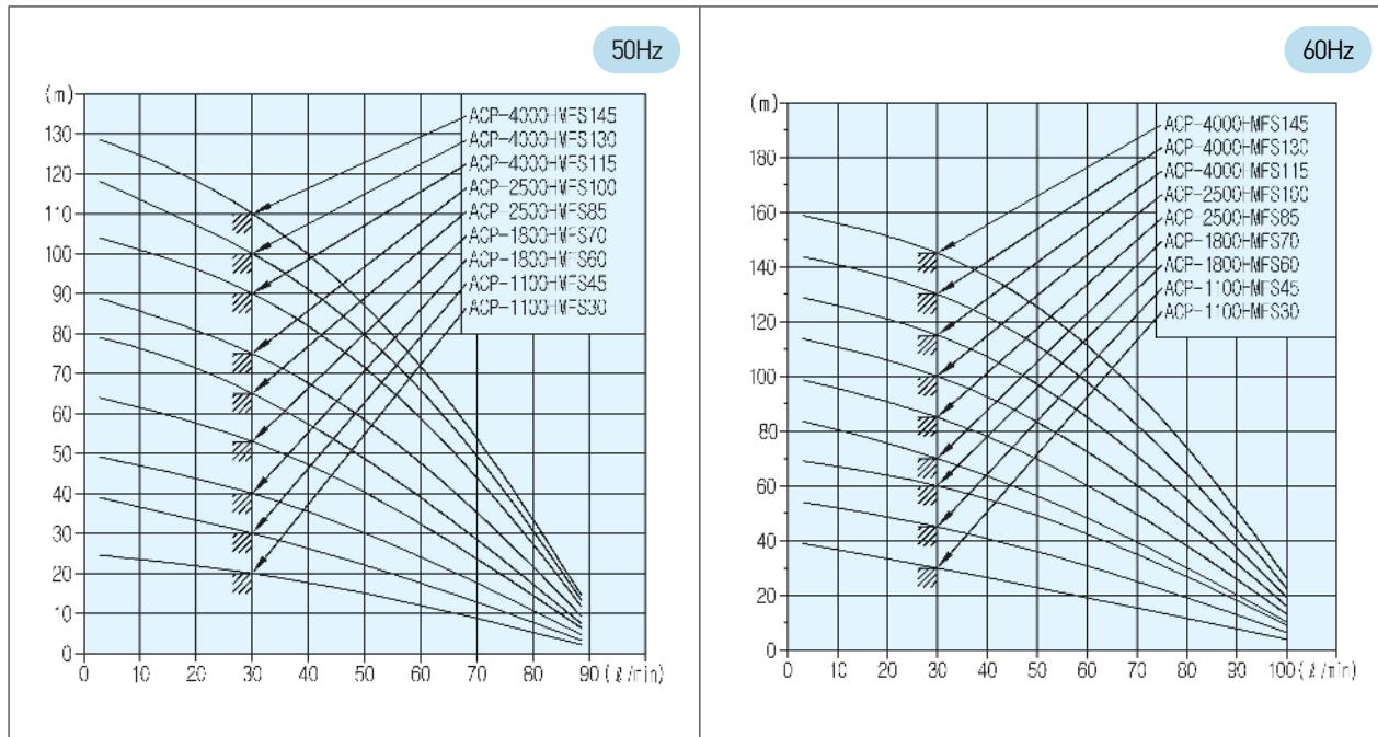
※위 Data는 유온 40°C, 절도 2cSt에서 작성 되었다. (Above data was tested in the viscosity 2cSt, oil temperature. 40 °C.)
