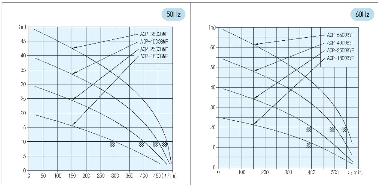
\*위 Data는 유온 40°C, 점도 2cSt에서 작성 되었다. [Above data was tested in the viscosity 2cSt, oil temperature. 40 °C.]
