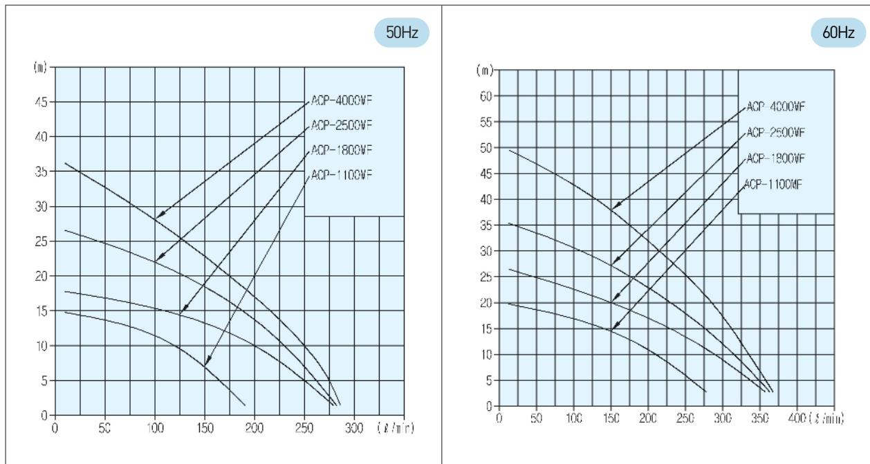
※위 Data는 유온 40°C, 점도 10cSt에서 작성 되었다. (Above data was tested in the viscosity 10cSt, oil temperature. 40 °C.)
