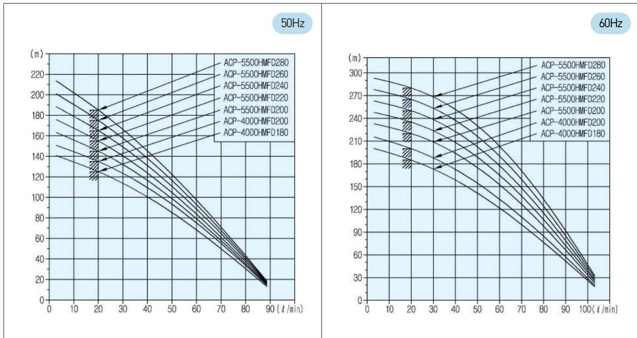
\*위 Data는 유온 20°C, 점도 2cSt에서 작성 되었다. (Above data was tested in the viscosity 2cSt, oil temperature. 20°C.)
