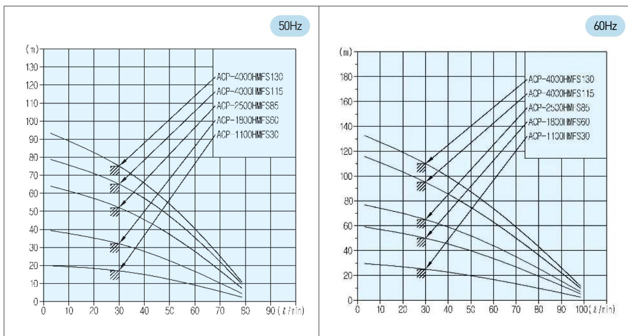
※위 Data는 유온 40°C, 절도 10cSt에서 작성 되었다. (Above data was tested in the viscosity 10cSt, oil temperature. 40 °C.)
