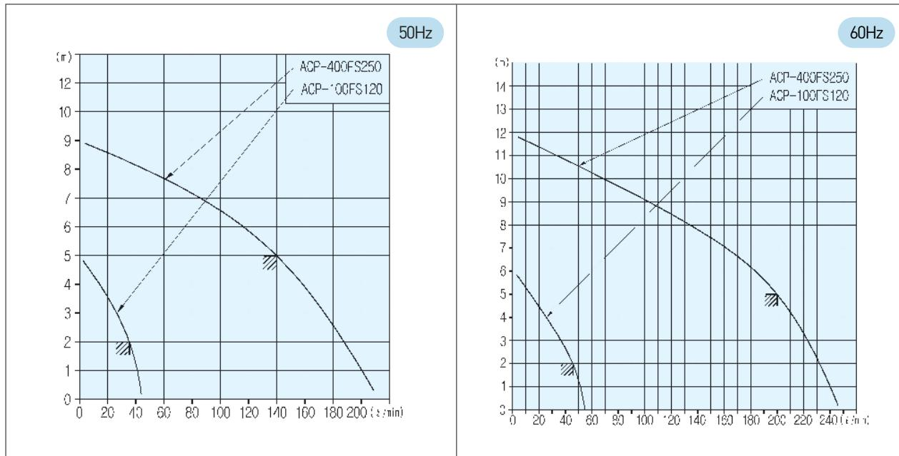
※위 Data는 유온 40°C, 절도 2cSt에서 작성 되었다. [Above data was tested in the viscosity 2cSt, oil temperature. 40 °C.]
